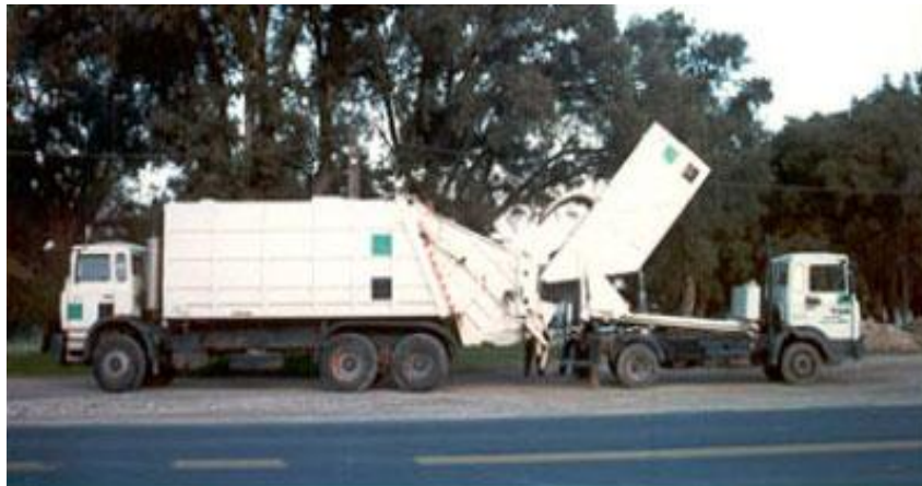
Transferencia de residuos domésticos de camión de recogida (satélite) a camión recolector-compactador de gran capacidad (nodriza), para su transporte a la planta de tratamiento de residuos.
